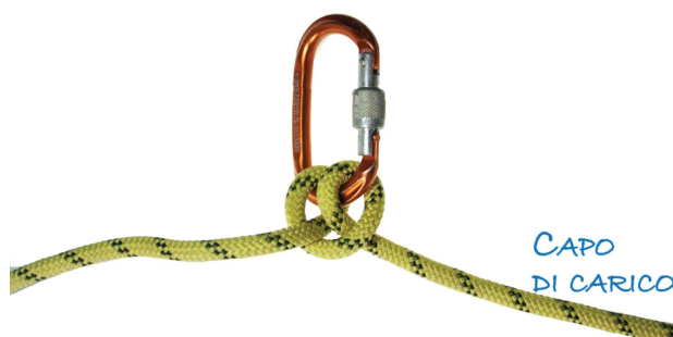
Fig. 5: Assuccare il nodo tirando un ramo alla volta
